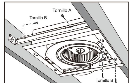
2c. Montaje sobre una vigueta en I
